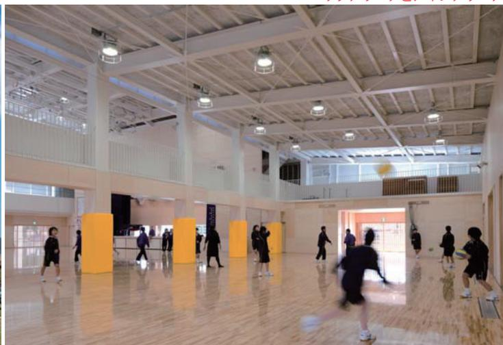
この建築の最大の特長は、屋根の雨水処理と採光の確保の仕方にある。雨樋は永年の自然環境を考慮すべしなほうが良い。そこでこの建築では、雨水が地上部分まで樋を設けずに自然に流れるように考えられている。それがこの建築の外観の特長の『流れる曲線を描く屋根』となって表現されている。そしてもう一つ、内部への採光の確保の仕方については、アリーナに於ける直接採光はスポーツのシーンとしてはあまり好まれるものではないが、自然採光による照度の確保はE C Oの観点から考えても必要不可欠なものである。しかし、ただ開口部を確保しても眩しくて競技に影響を与えてしまう。この相反するものをこの建築では十分な間接光により、けして眩しくない『光で満たされた柔らかな空間』として提案している。あくまでも1階部分は通風を第一に考え全面開口とし、カーテンによるグレア（眩しさ）調整がし易い環境を生み出しながら、グレア上の問題の出やすい2階、3階部分の開口部をギャラリーの手摺りの反射による柔らかな間接光として扱っている。
